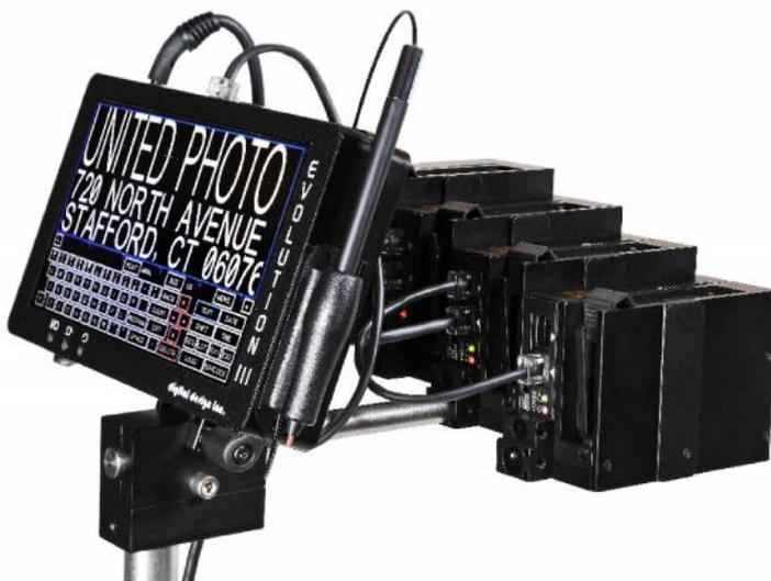
Le **CLEANCODE III** est capable de contrôler jusqu'à 8 têtes d'impression, 4 têtes de part et d'autre de la ligne de production qui doivent imprimer le même message.
