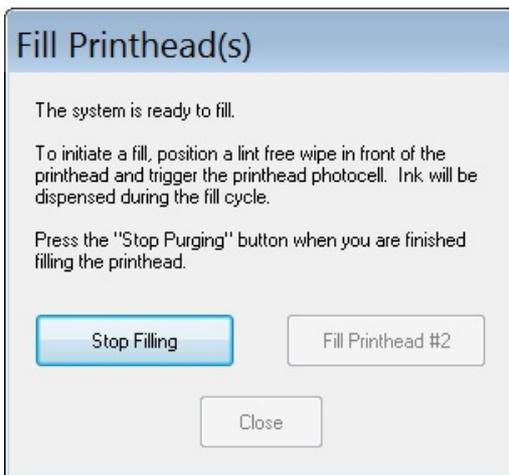
Chaque fois que le capteur est activé, le système fera un bref remplissage de tête. Pour arrêter le remplissage désactivé le capteur et attendre un peu ou désactivé la cellule et toucher le bouton « arrêt remplissage »
